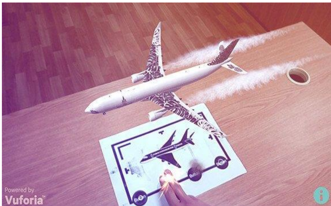
Gambar 2. 2 Contoh penerapan marker based tracking pada augmented reality
