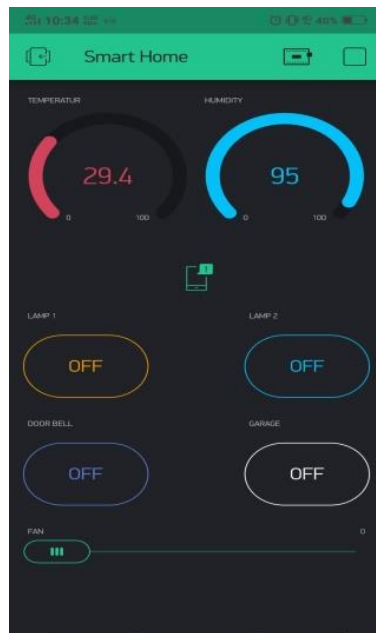
Gambar 4.4. Pengujian Sensor suhu DHT11
