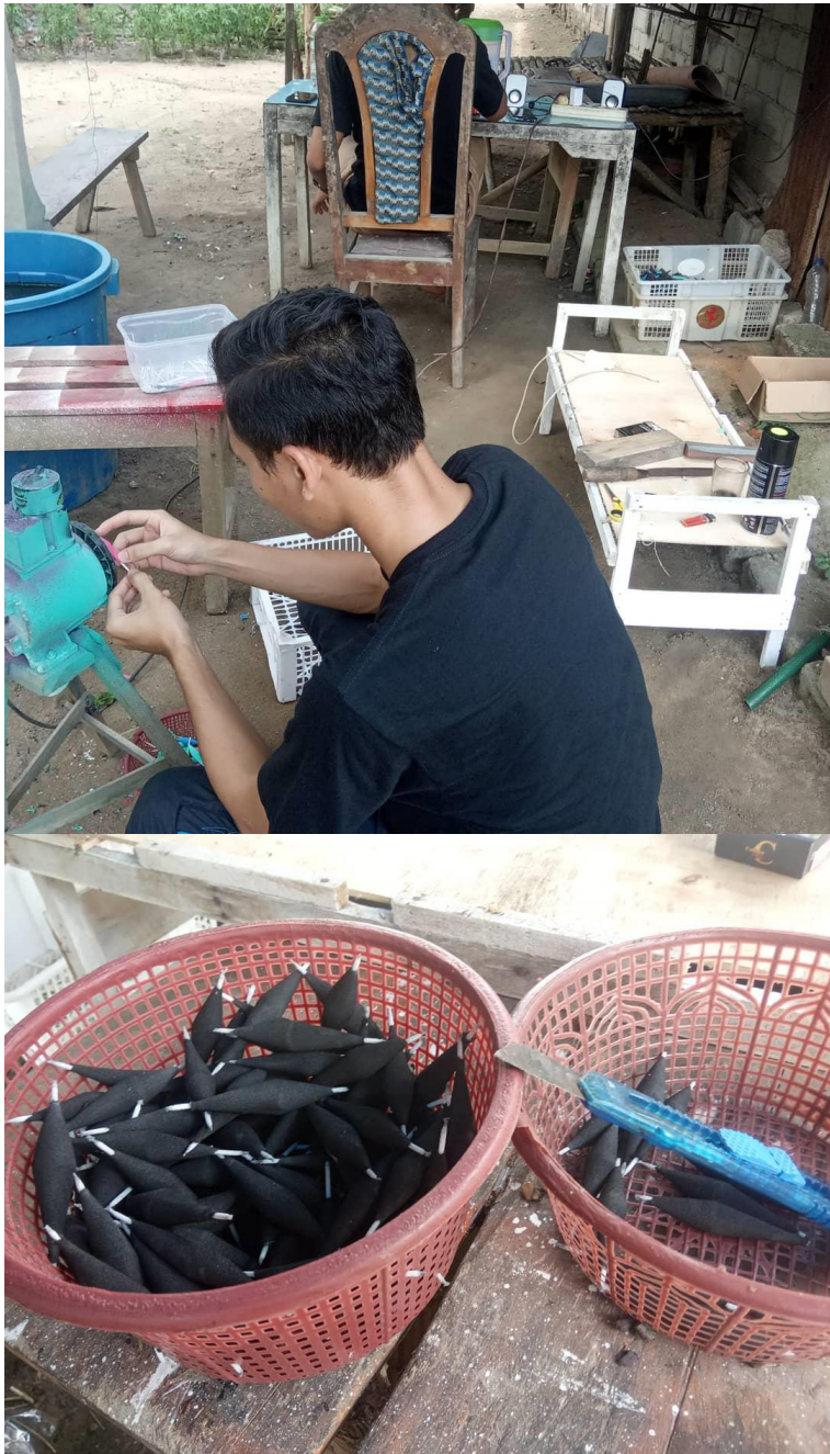
Gambar 18. Proses penghalusan dan pembentukan gabus menggunakan mesin
