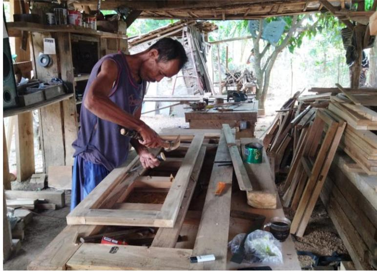
Gambar 2.2 Proses Pemahatan Kerangka Jendela
