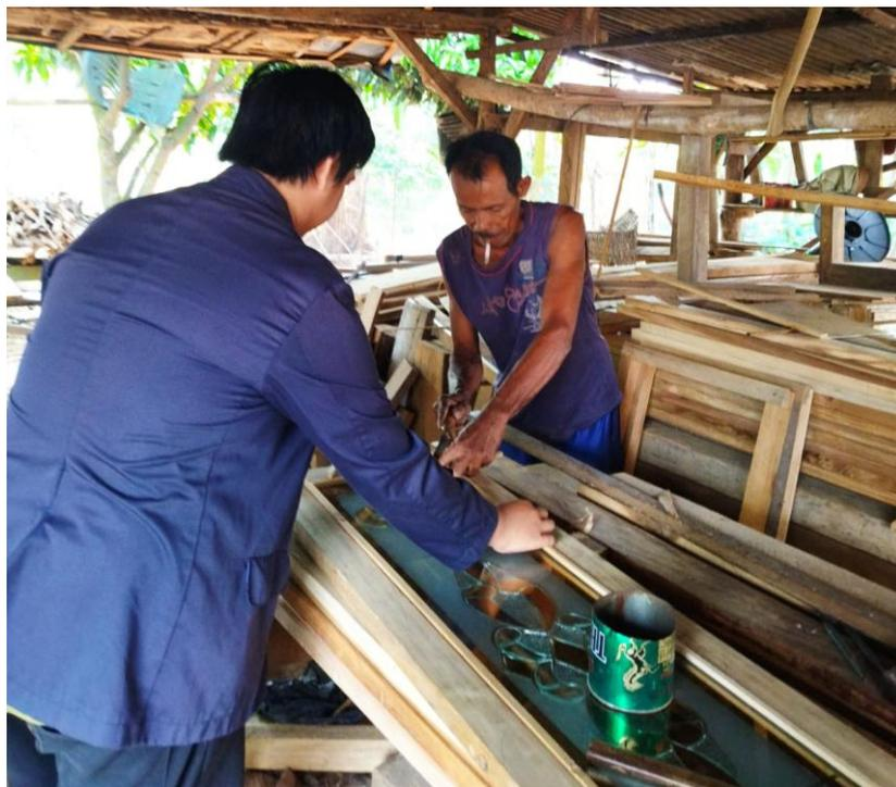
Gambar 2.3 Pemasangan Kaca Pada Kerangka Jendela
