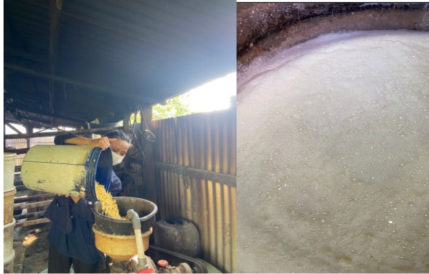
Proses Penggilingan Kedelai dan Proses Perebusan Kedelai
