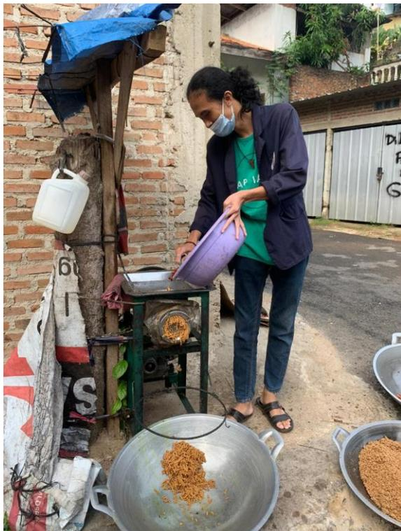
Proses Pengolahan Kacang Tanah dengan Menggunakan Mesin
