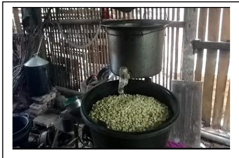
Gambar 2.3 1 Proses Penggilingan Kedelai yang akan dipakai untuk membuat Tahu
