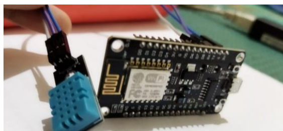
Gambar 3.3 Rangkaian sensor DHT11 Ke NodeMCU
