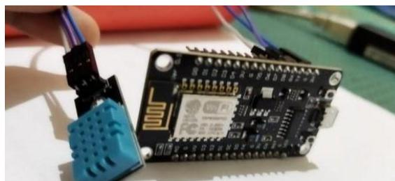
Gambar 3.3 Rangkaian sensor DHT11 Ke NodeMCU
