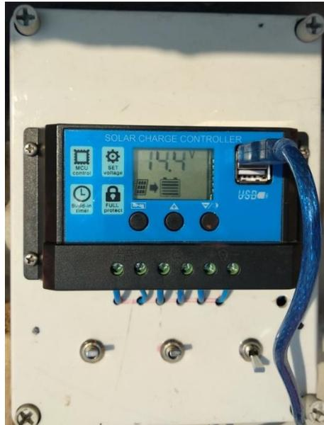
**Gambar 4. 1 Pengujian pada output LCD solar charge controller**
