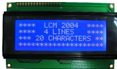
Gambar 2.5 LCD ( Liquid Crystal Display ) 20 x 4 (sumber: www.elektrojo.com )
