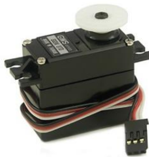
Gambar 2.6 Motor Servo (sumber: http://zoniaelektro.net )
