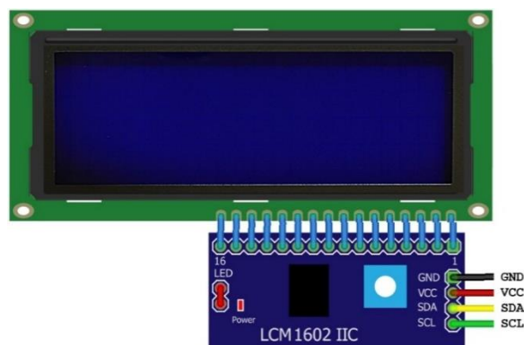
Gambar 3.7 Pengkabelan Modul LCD ( Liquid Crystal Display ) 20x4
