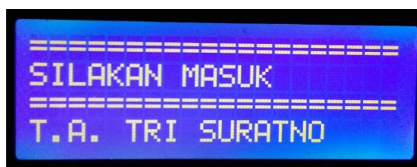
Gambar 4.3 Tampilan LCD Saat Input Fingerprint Cocok Dengan Database
