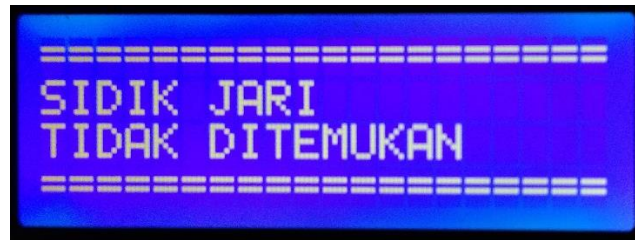
Gambar 4.4 Tampilan LCD Saat Input Fingerprint Tidak Cocok
