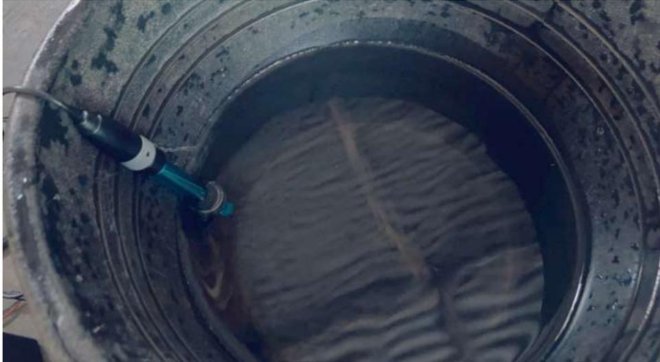
**Gambar 4.3 Tampilan pengujian Sensor pH Meter**
