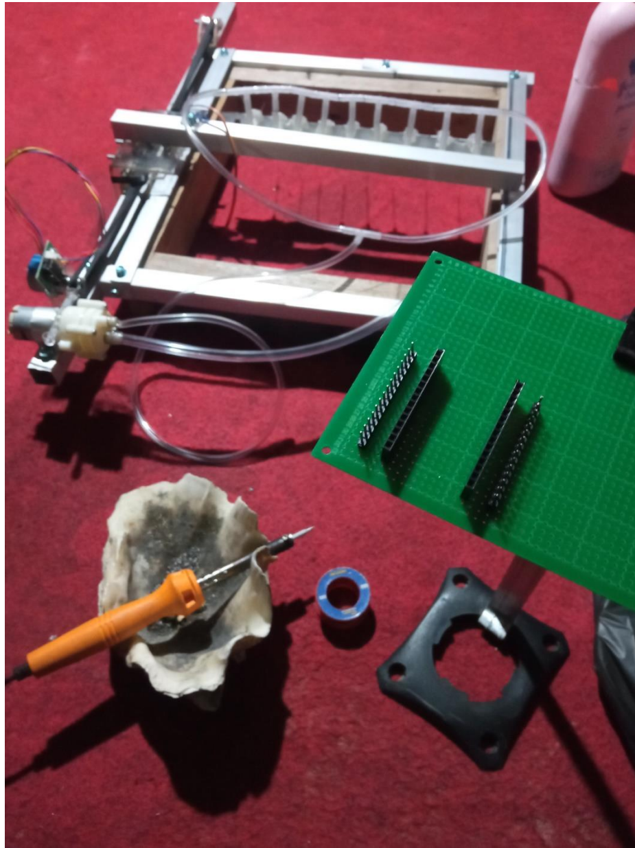
Proses Solder Komponen Elektronik Alat Pemanenan Madu Klanceng Otomatis
