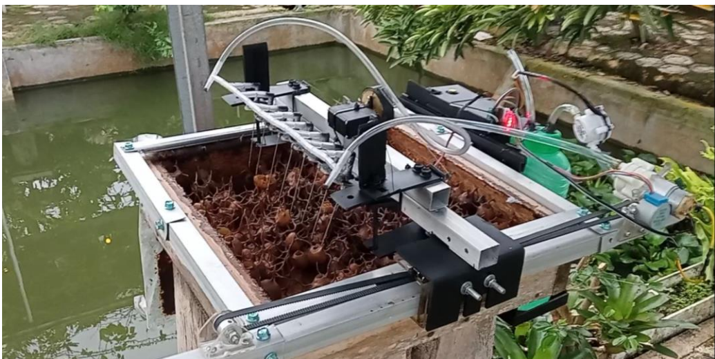
Alat Pemanenan Madu Klanceng Otomatis Yang Telah Dipasangkan Pada Sarang Lebah Klanceng
