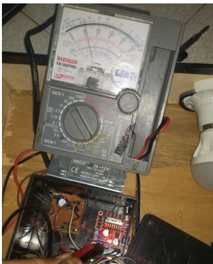
Gambar 4. 2 Pengujian Rangkaian Catu Daya dengan Multimeter
