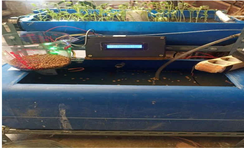
Gambar 4. 1 Implementasi alat pemberi pakan ikan pada media aquaponik
