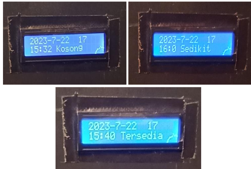
Gambar 4. 8 Pengujian LCD dan RTC
