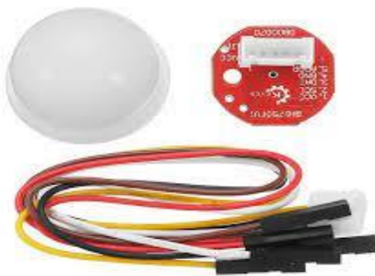
Gambar 2.6 Sensor Intensitas Cahaya BH1750FVI
