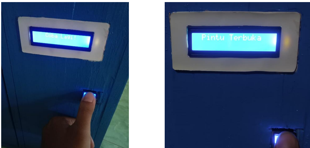
Gambar 4.3 LCD Ketika Tidak Terdeteksi Dan Pintu Terbuka
