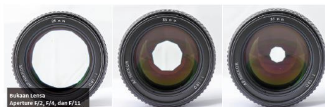
Gambar 2.1 Ilustrasi Bukaan Lensa/Diafragma/Aperture
