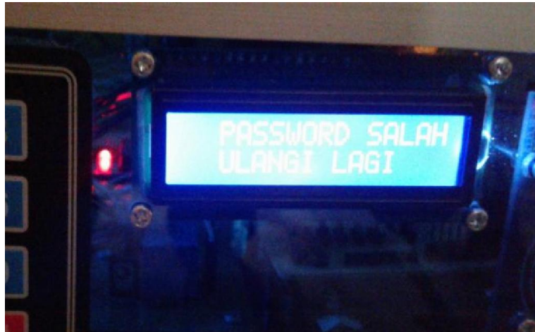
Gambar 33. Tampilan LCD Sesudah Password Salah Dimasukkan
