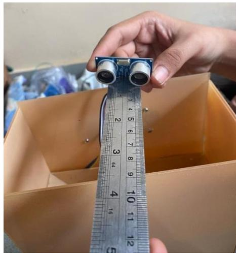
**Gambar 4.2 Perbandingan Pengujian Sensor Ultrasonik dengan Penggaris**
