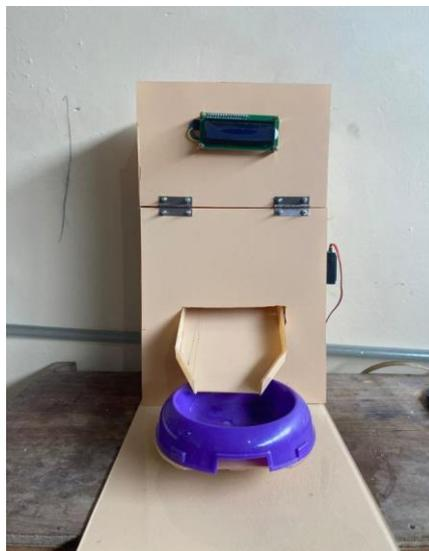
**Gambar. 4.1. Bentuk Fisik Alat**
