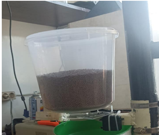
Gambar 4. 2 Pengujian berat Sensor Loadcell
