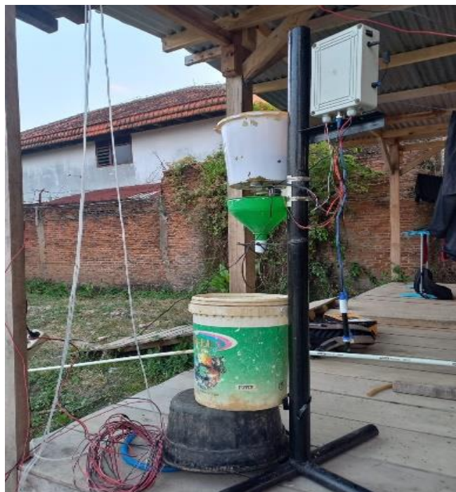
Gambar 4. 1 Bentuk Fisik Sistem Monitoring Pemberian Pakan Ikan Otomatis Dan PH
