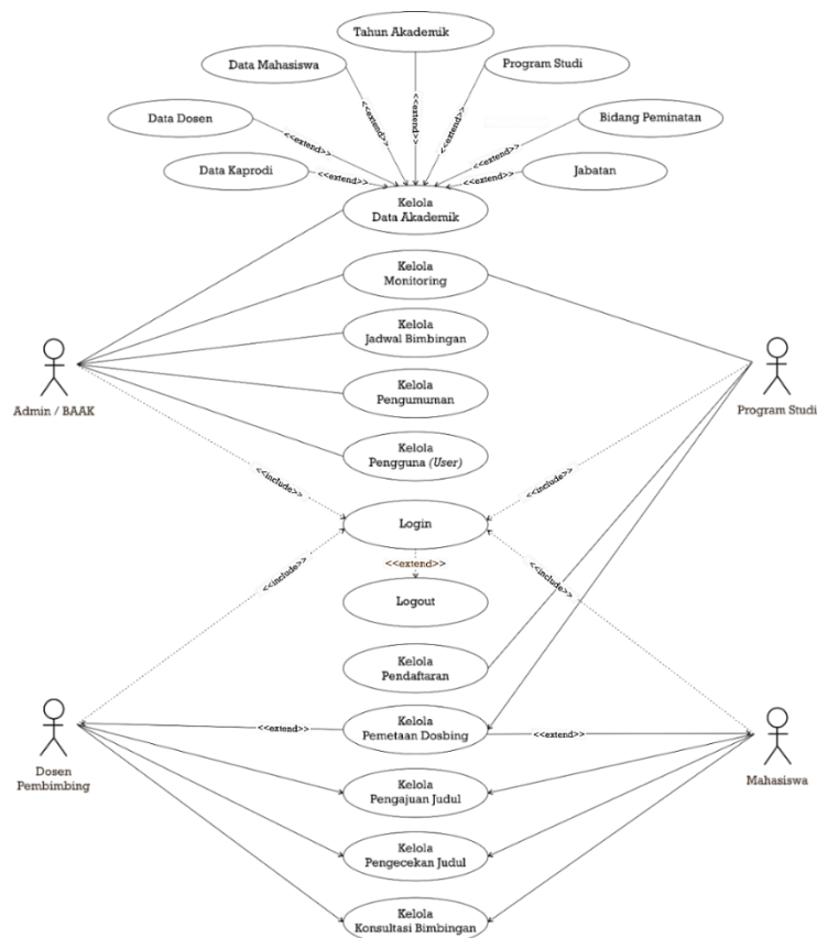
Gambar 3.5 Use Case Diagram yang diusulkan.
