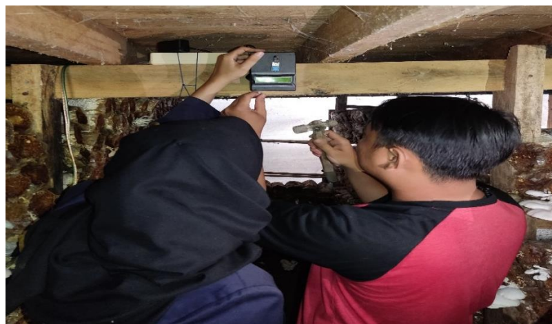
Lampiran 1. 21 Intalasi alat monitoring suhu dan kelembapan
