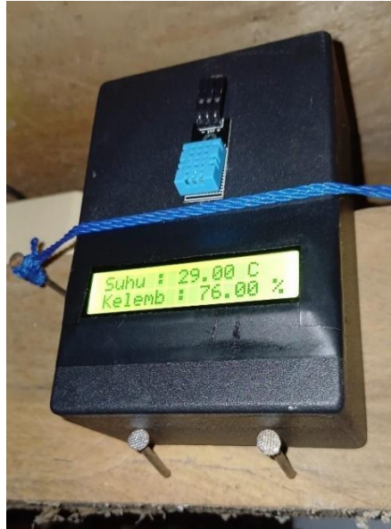
Gambar 2. 8 Pengujian alat monitoring suhu dan kelembapan
