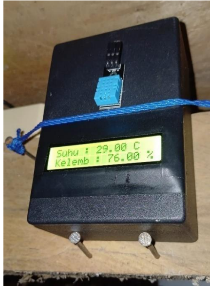
Gambar 2. 10 Pengujian alat monitoring suhu dan kelembapan
