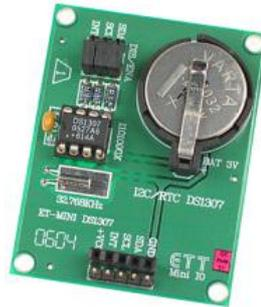
**Gambar 2.3. Real Time Clock (RTC DS1307)**
