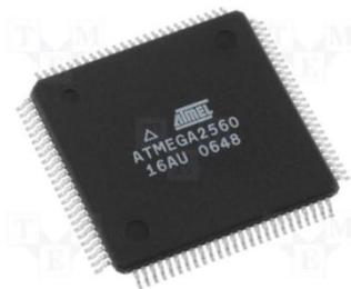
**Gambar 2.19 ATmega 2560 pada Arduino Mega 2560**
