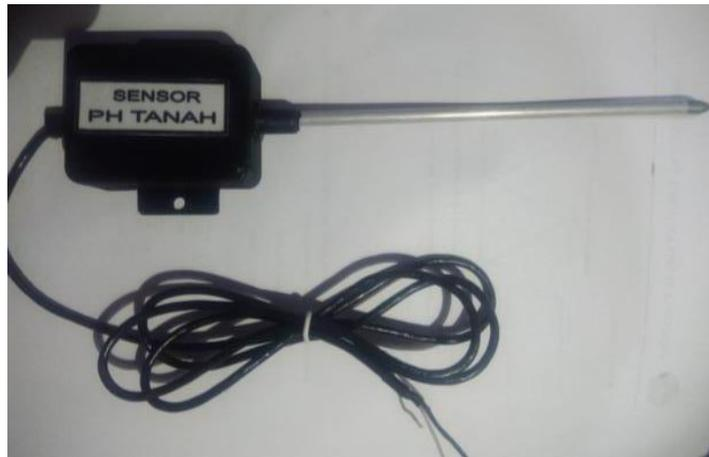
**Gambar 2.2 Sensor pH Tanah**
