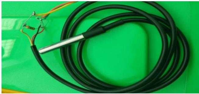
Gambar 2.2 Bentuk Fisik Sensor Suhu DS18B20
