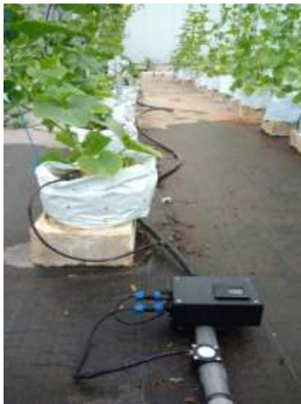
Gambar 4. 5 Instalasi Water Flow Sensor Dan Sensor Viscosity Pada Jalur Penyiraman
