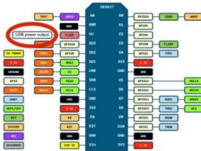
Gambar 2.3, GPIO NodeMCU ESP8266 v3
