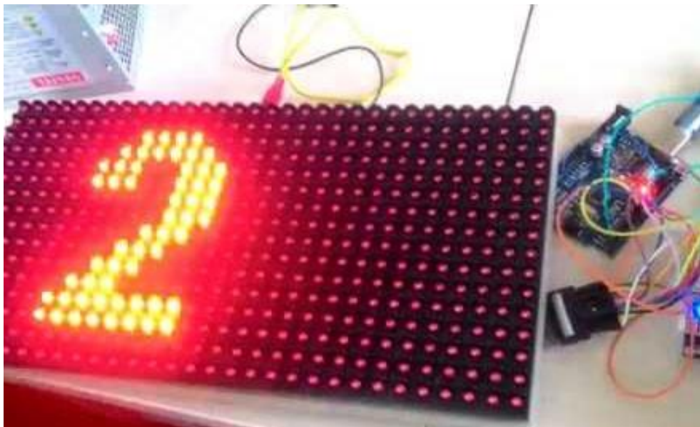
Gambar 3.12 Tampilan DMD P10 Pada Saat Countdown
