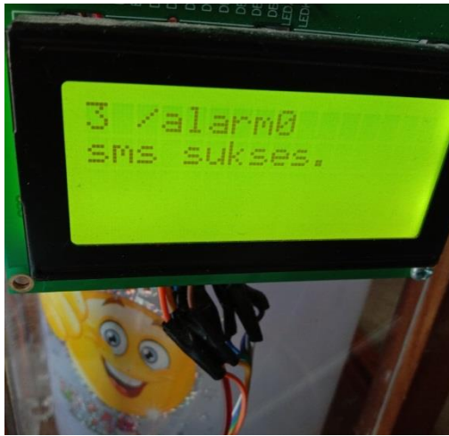
Gambar 4.7 LCD Menampilkan Alarm 0 Kondisi Air Dan Tanah Aman.
