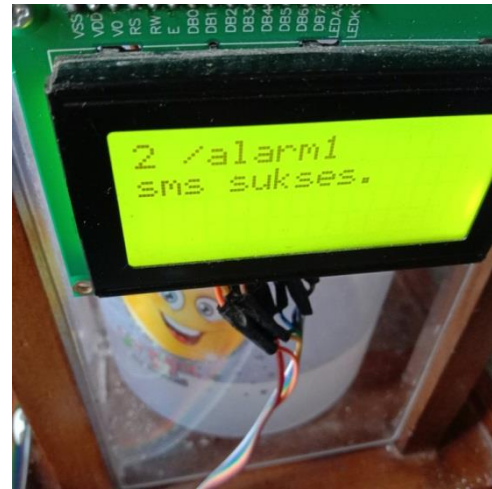
Gambar 4.8 LCD Menampilakn Alarm Level 1 Kondisi Banjir WASPADA.
