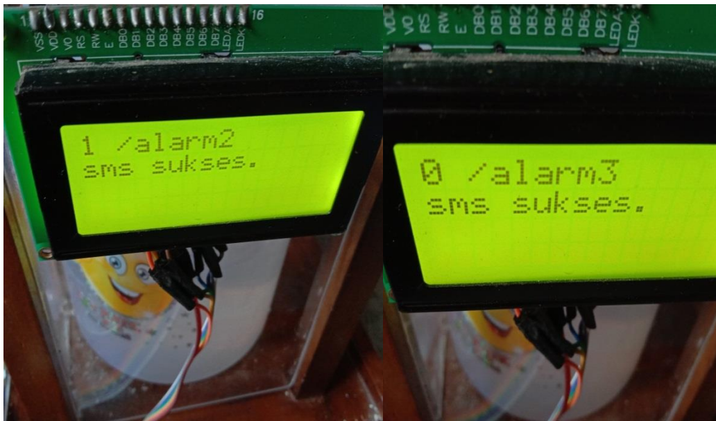
Gambar 4.9 LCD Menampilkan Alarm Level 2 Kondisi Banjir AWAS
