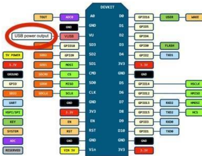
Gambar 2.4, GPIO NodeMCU ESP8266 v3
