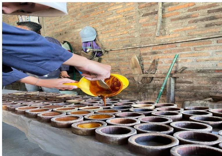
Gambar 2.3 Proses Pembuatan Gula Kelapa
