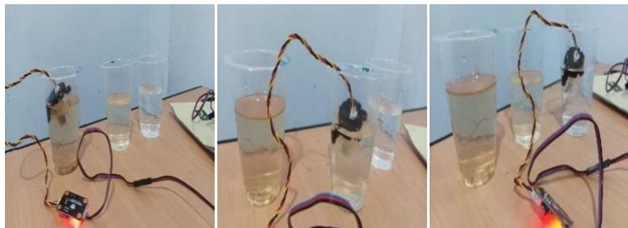
Gambar 4.3 Pengujian Sensor Turbidity untuk Sampel Air (a), Sampel Air (b), Sampel Air Sumur (c)
