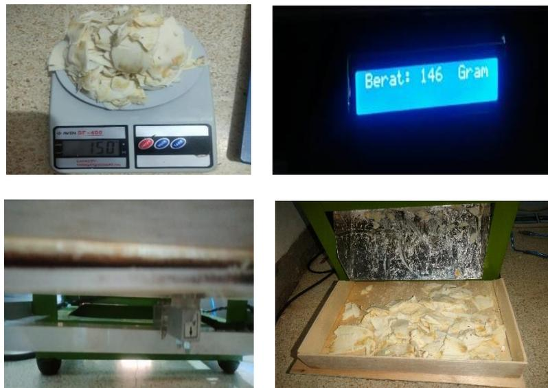
**Gambar 4.2 Perbandingan Timbangan Biasa Dan Timbangan Load Cell**
