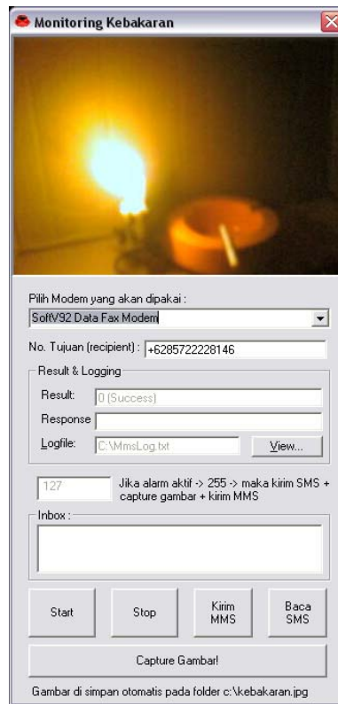
Gambar 7. Realisasi program sistem pendeteksi kebakaran
