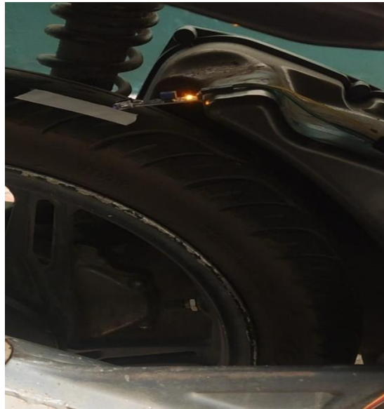
Gambar 4. 4 Penempatan sensor pada kendaraan
