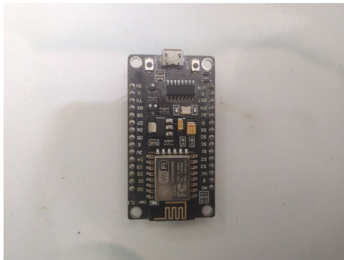
Gambar 4.1 NodeMCU V3 ESP8266
