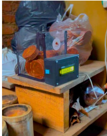
Gambar 2. 8 Penguji cobaan alat monitoring suhu dan kelembapan
