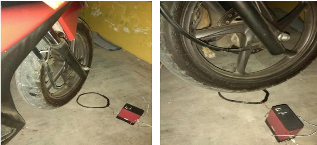
**Gambar 4.2 Pengujian Sensor loop dengan Sepeda Motor**
