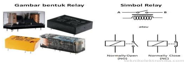
Gambar 2.3 Gambar dan Simbol Relay
