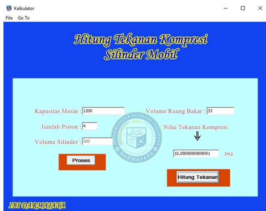
Gambar 4.12 Tampilan Halaman Hitung Tekanan Pada Saat Pengujian
