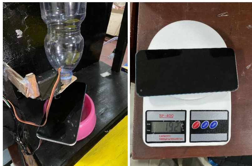
Gambar 4. 3 Pengujian berat yang di bandingkan dengan timbangan asli
