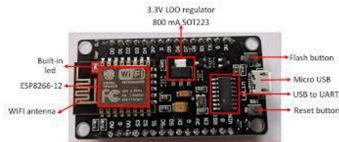
Gambar 2.7 GPIO NodeMCU ESP8266 v3
