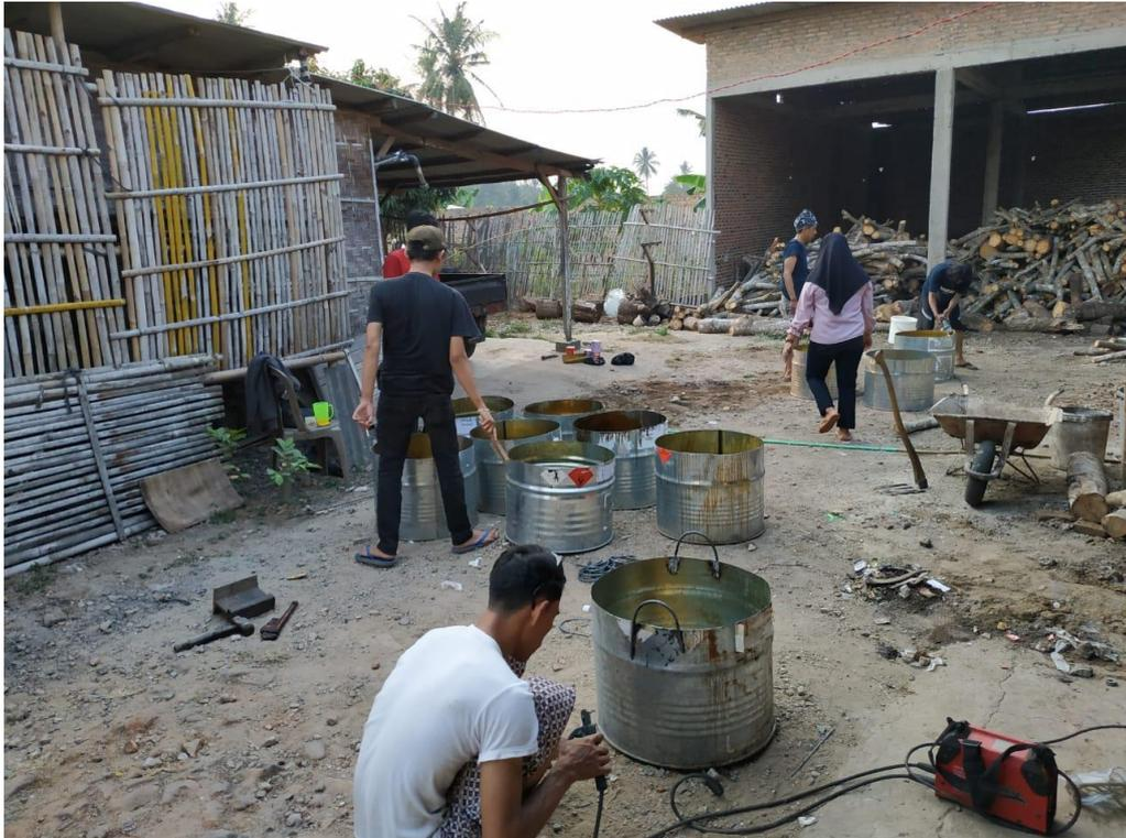
Gambar proses pembuatan tong sampah
