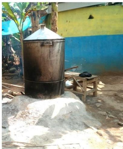
**Gambar 3.7 Alat Pengukus Ampas Tahu**
