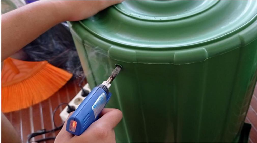
Gambar 2.4 Membolongkan ember untuk pembuangan air di Ember
